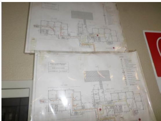
FIG. 1.3 Planimetrie di esodo con simbologia non conforme alla normativa
