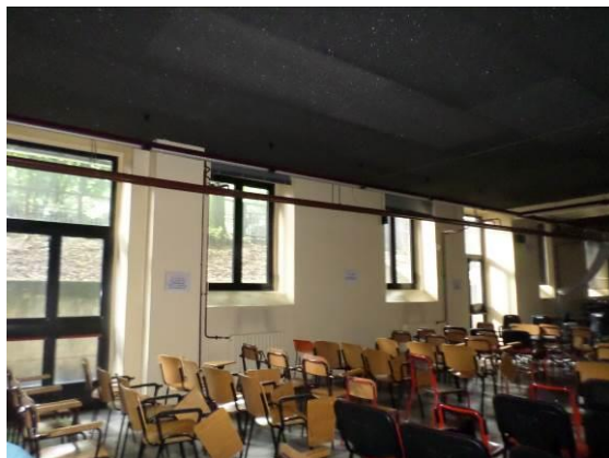
FIG. 7.8 Uscite d'emergenza non segnalate
